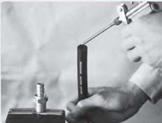
ホースをナイフ等で必要な長さに軸方向と直角に裁断してください。ホース内面と口金具のインサート部分に、水、または石けん水をつけてください。
