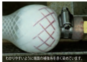
わかりやすいように端面の補強糸を赤く染めています。
